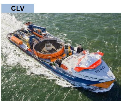
CLV Van Oord(NL) : 승선인원 90명 122.68(L)X27.53(W), 7,015tons 케이블 적재중량: 5,000tons
