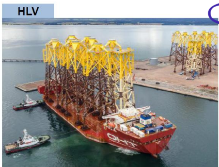
HLV OHT : 자켓구조물 10기(75m-80m), 해상변전소 1개 고중량물(해상구조물) 운송 및 설치용도
