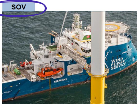
SOV ULSTEIN : Wind Farm Support Vessel (2016) 풍력터빈 시운전 및 운영단계 작업자 및 부품장비 등 연경 이송 60명 거주공간(작업자 40명)
