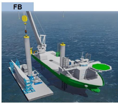
FB DEME Offshore(US) : Barge Master 동적보정기술적용 - 안전한 인양작업 및 작업성 향상 빈야드 해상풍력 1(미국) : Haliade-X 62대 미국국적 예인선을 이용한 이송(Jones Act) (현장)WTIV, (항만운송)피더바지
