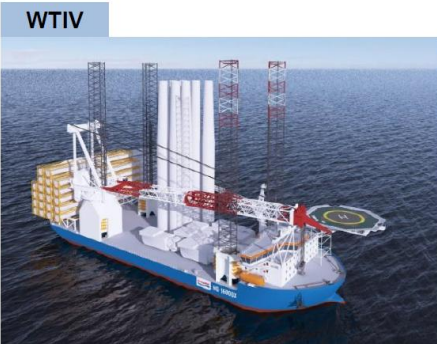
WTIV 대우조선해양 수주: NG-16000X 148m(L)X56m(W), 14~15MW 터빈 5대 수심 65m 작업 가능 2600ton급 크레인 발주처 : Eneti Inc.(3829억, 2025 Q1)
